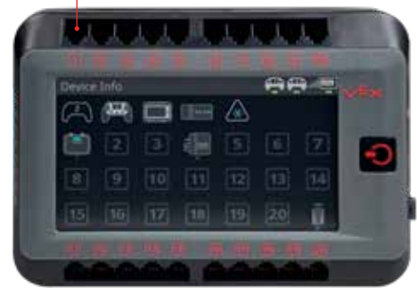
21 identische Smart-Ports zum Anschluss von Sensoren und Aktoren
