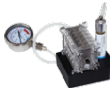
Anwendungsversuch III Umgang mit Wasserstoff-Druck-Systemen (Dichtigkeits-test)
