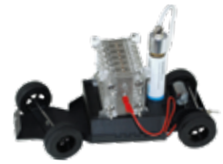
Anwendungsversuch II Elektrischer Antrieb mit Druckspeichersystem
