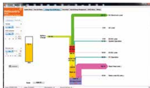
Energiefluss und Wirkungsgradbetrachtung Leistungsbilanzierung des Gesamtsystems Echtzeit-Sankey-Diagramm
