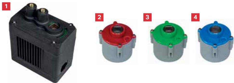
Der integrierte Motorcontroller, der Winkelkodierer und die von der Batteriespannung unabhängige Motorleistung machen den V5 Smart Motor zum perfekten Robotikantrieb. Mit dem Wechselgetriebe können Drehzahl und Drehmoment des Motors für den jeweiligen Einsatz angepasst werden.
