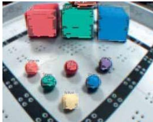
Der Vision Sensor mit einem dual ARM M4/M0 Prozessor erfasst, verfolgt und zählt Objekte. Positionsveränderungen werden in X-, Y- und Z-Achse an das Robot Brain zurückgegeben.
