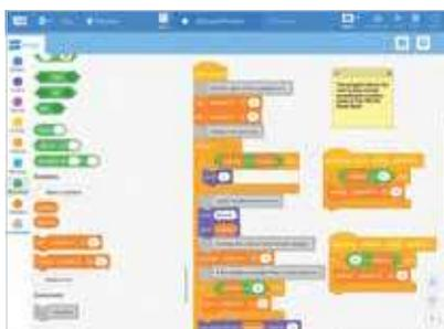
Im Programm lässt sich der grafisch erstellte Code in C++-Code konvertieren, sodass ein Wechsel von der einfachen grafischen Oberfläche auf die komplexere, aber leistungsfähigere textbasierte Oberfläche problemlos möglich ist.
