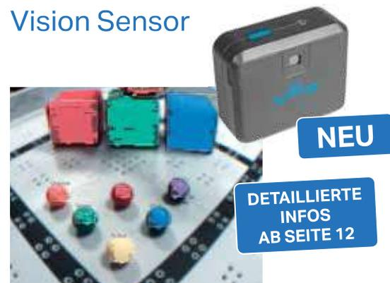
Der Vision Sensor verfolgt und zählt Objekte. Positionsveränderungen werden in X-, Y- und Z-Achse an das Robot Brain zurückgegeben.
