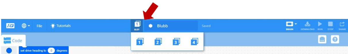
Wenn das System mit einem Robot Brain verbunden ist leuchtet das Symbol Brain grün und das Programm wird durch Drücken des Button „Download“ auf das Robot Brain übertragen. Anschließend kann das Programm mit den Buttons „RUN“ und „STOP“ gestartet und gestoppt werden. Das Programm kann auch über die Menüauswahl „Programms“ auf dem Brain gestartet werden.
