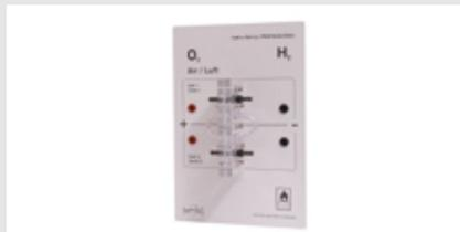
Die leistungsstarke Doppel-Brennstoffzelle dient zur Stromerzeugung aus Wasserstoff und Sauerstoff. Die beiden Brennstoffzellen können parallel und in Reihe verschaltet werden. Sie basiert auf der PEM-Technologie, die in der Entwicklung von Brennstoffzellenanwendungen am weitesten verbreitet ist, z.B. für Kraftfahrzeuge oder stationäre Stromversorgungen.
