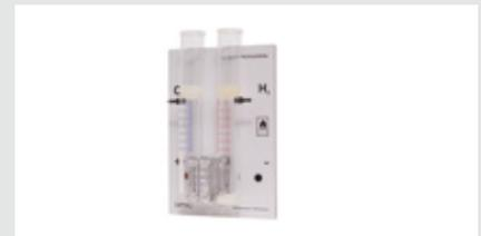
Der Elektrolyseur dient zur Aufspaltung von Wasser in Wasserstoff und Sauerstoff. Aufgrund der PEM-Technologie wird er mit destilliertem Wasser betrieben – ohne ätzende Laugen oder Säuren. Die integrierten, mit Maßeinheiten versehenen Gasspeicher visualisieren den klassischen Wasserspaltungsversuch wie mit dem Hoffmann-Apparat.
